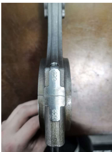
Рис. 20. Совмещение парных номеров шатуна и его крышки
