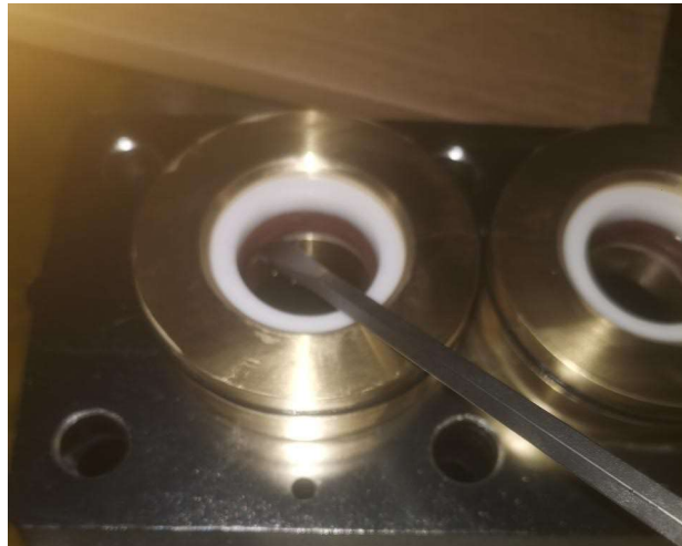
Рис. 6. Инструмент для демонтажа уплотнений и извлечение главного водяного уплотнения
