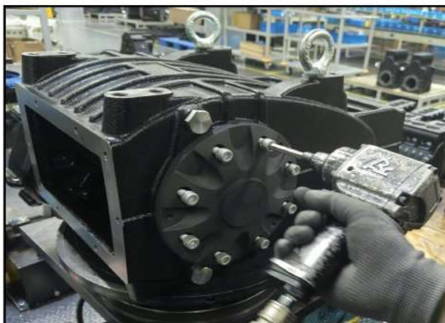
Рис. 19. Расположение крепёжных винтов боковой крышки и фланца выходного вала
