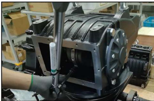
Рис. 21. Затяжка болтов крышки шатуна динамометрическим ключом
