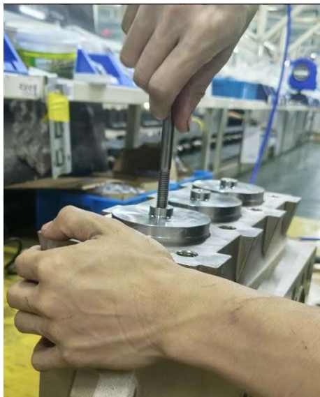
Рис. 2. Извлечение клапанных заглушек
