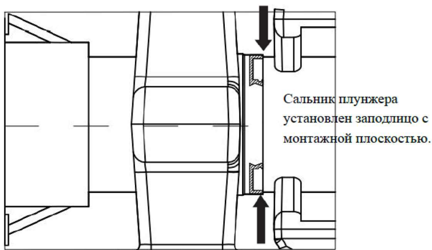
Рис. 22. Монтаж сальника плунжера: заподлицо с монтажной плоскостью
