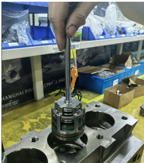
Рис. 3. Извлечение обратного клапана
