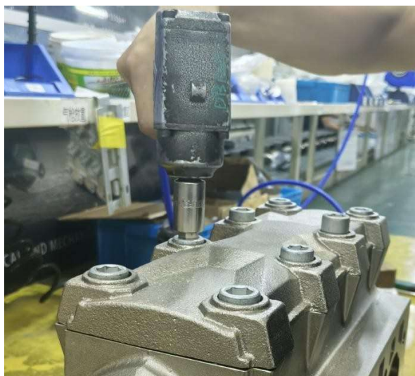
Рис. 1. Ослабление крепёжных винтов крышки клапанов
