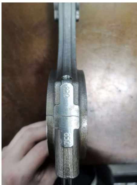
Рис. 14. Парная маркировка шатуна и его крышки
