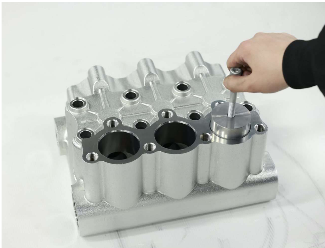
Рис. 2. Извлечение клапанных заглушек линии всаса
