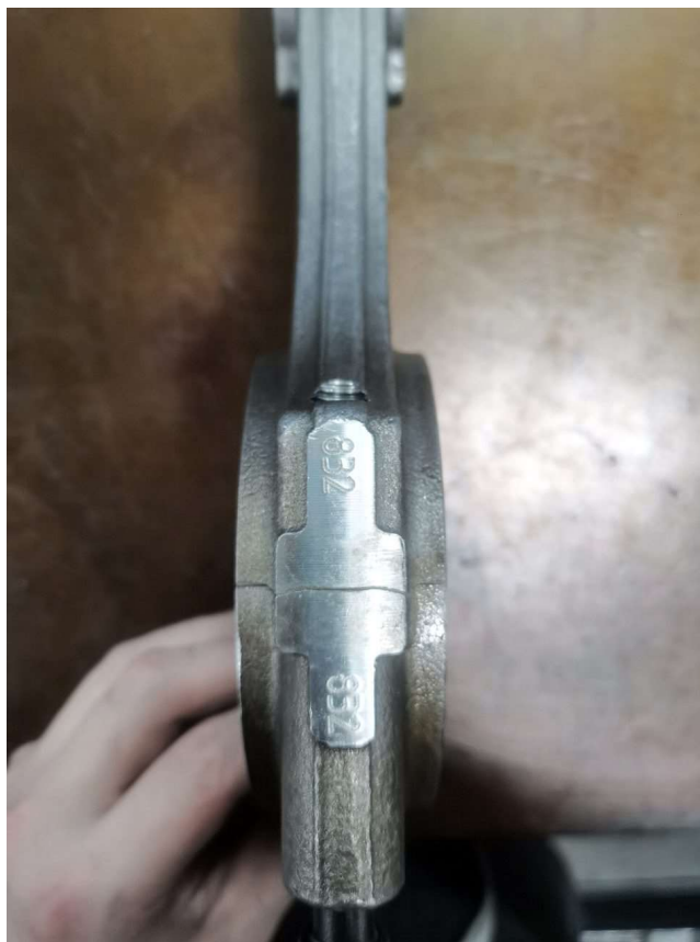
Рис. 22. Присоединение крышки шатуна по нумерации
