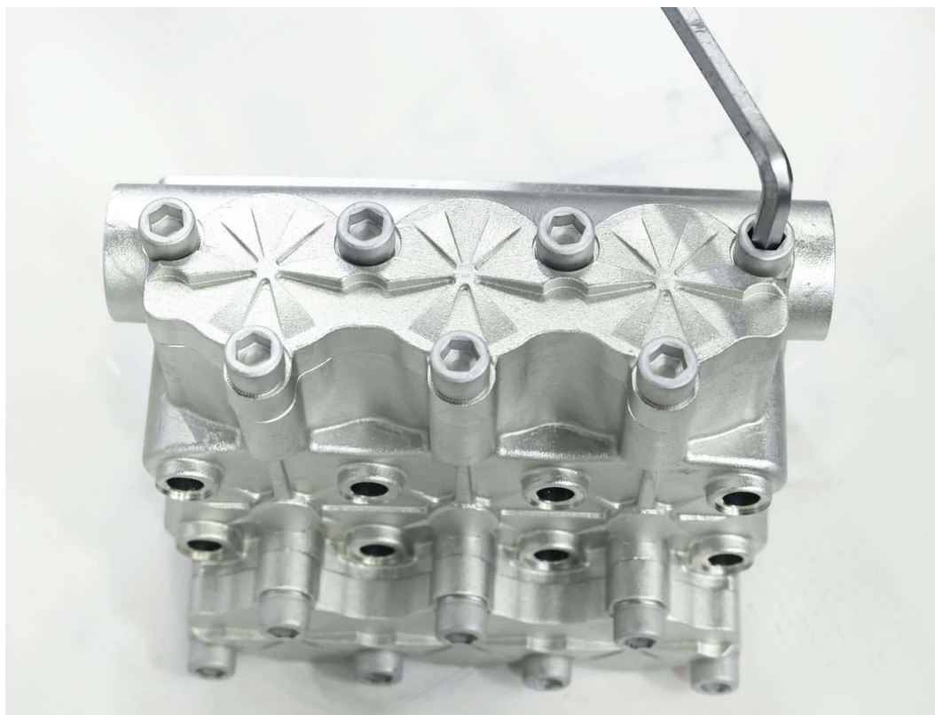
Рис. 1. Ослабление болтов M16×55 крышек клапанов
