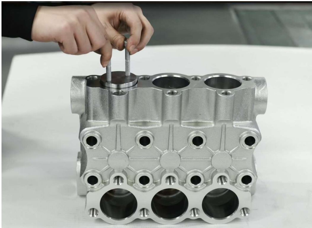
Рис. 3. Извлечение клапанных заглушек линии нагнетания
