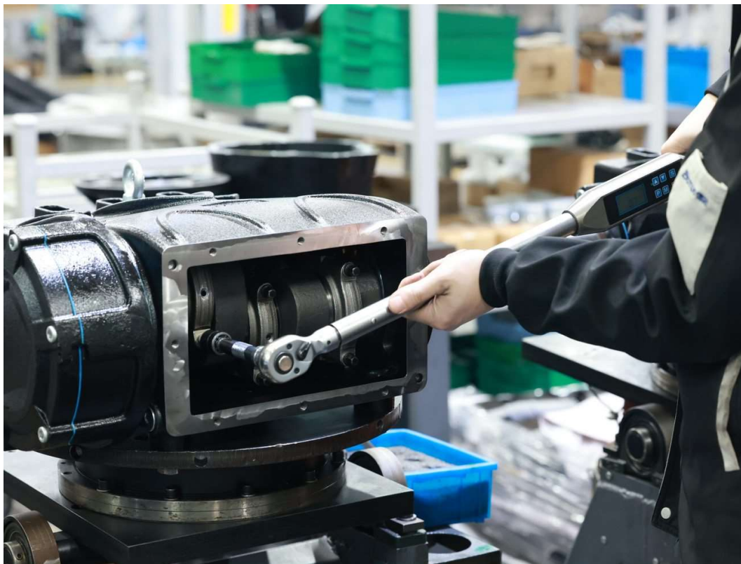
Рис. 23. Затяжка крышек шатунов динамометрическим ключом
