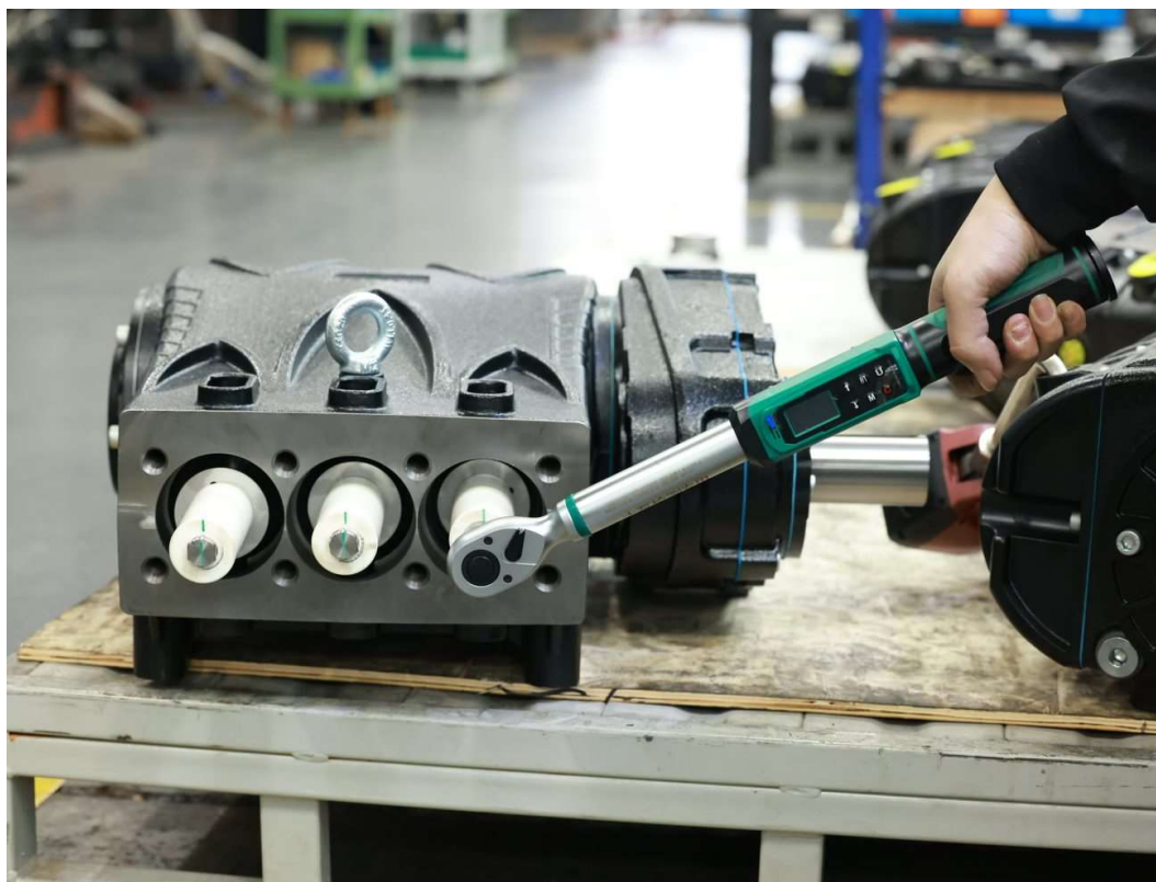
Рис. 11. Ослабление болта крепления керамического плунжера
