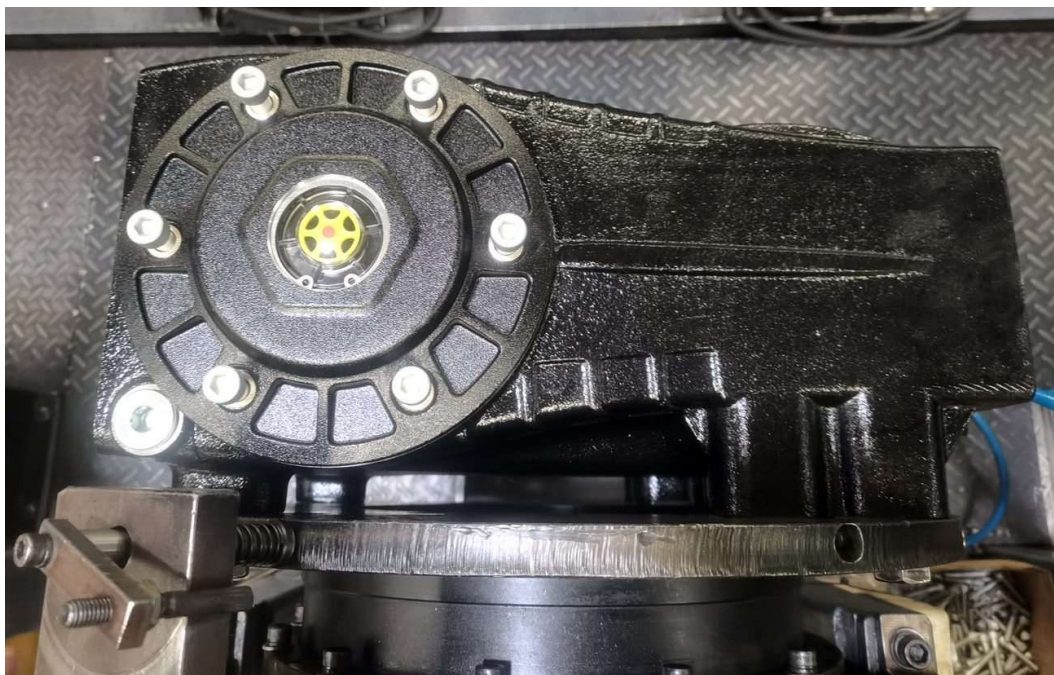
Рис. 16. Снятие фланца выходного вала и боковой крышки
