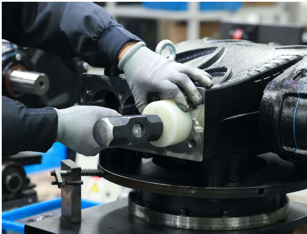
Рис. 25. Запрессовка сальника монтажным приспособлением
