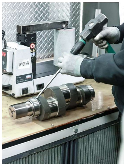
Рис. 26. Снятие внутренних колец подшипников съёмником
