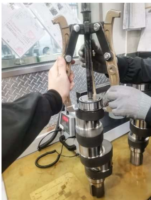
Рис. 26. Снятие внутренних колец подшипников съёмником
