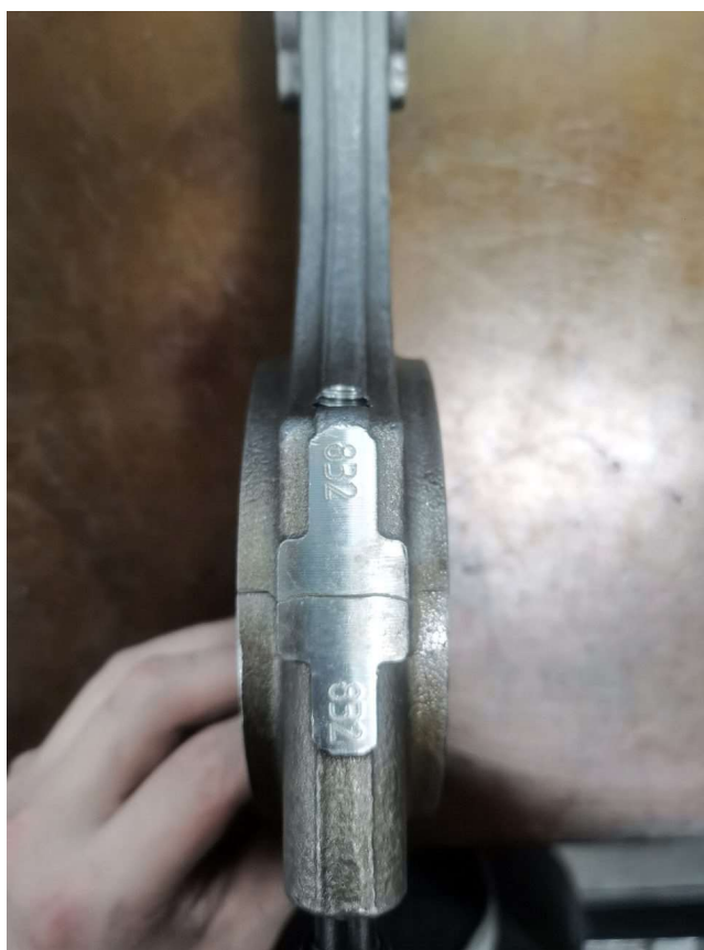
Рис. 15. Нумерация крышек шатунов и шатунов
