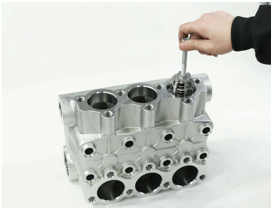
Рис. 4. Извлечение узла обратного клапана
