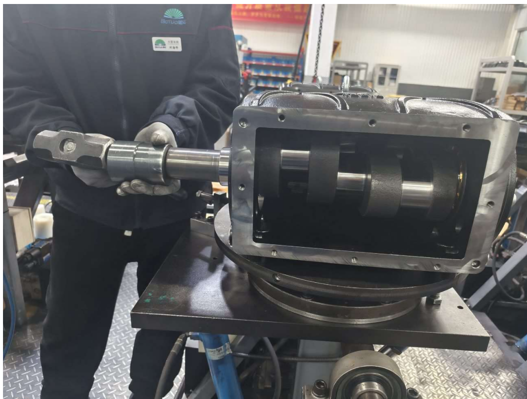
Рис. 17. Снятие подшипника надставкой / съёмником с торца выступающего вала
